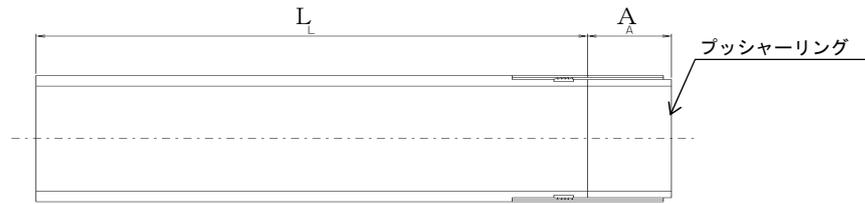
図3-6 SUSカラー付直管（先頭管アダプタなし）
